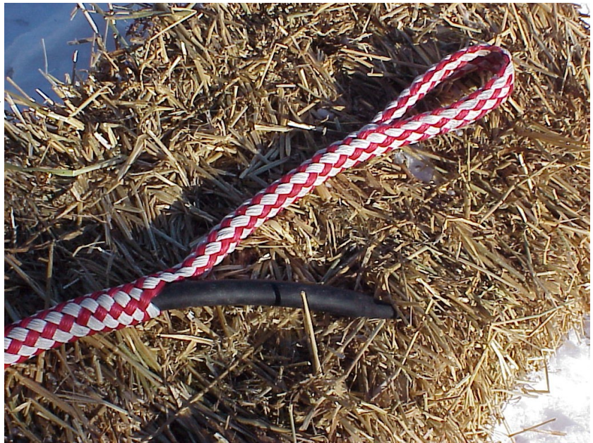
Abb.3: Nylon-Zugschoner; man sieht den harten Gummi-Einsatz um die Belastungsspitzen abzufedern
