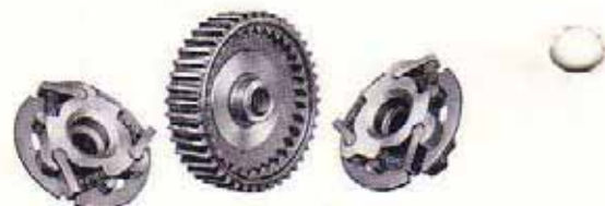
Die beiden Sperrklinkenplatten mit den Sperrklinken und das Hauptantriebszahnrad, in welches die Sperrklinken an den inneren Zahnkränzen eingreifen
