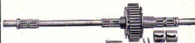
Achse der Ölbad-Grasmäher 4' und 3 1/2' mit Rollenlagern, etwas abgezogenen Sperrklinkenplatten und den Stahlhülsen für die beiden Rollenlager an der Getriebeseite
